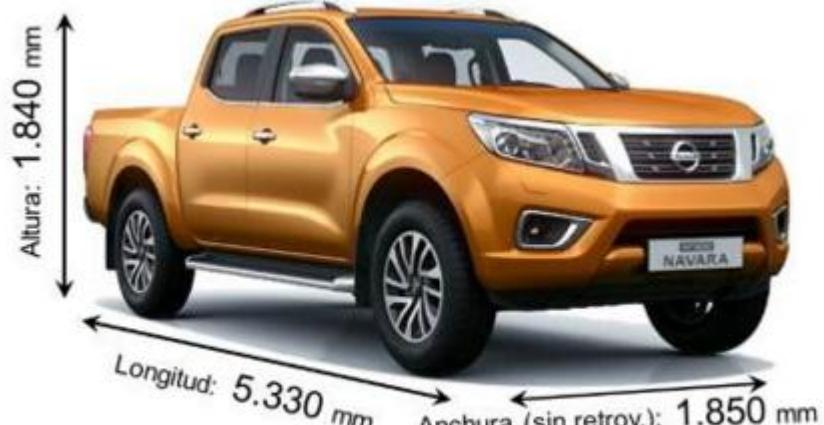
[medidasdecoches.com](http://medidasdecoches.com)(2.085mm con retrovisores)
